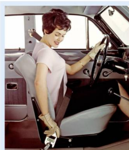
Трёхточечные ремни безопасности Когда: 1959 год Где: Volvo PV 544
